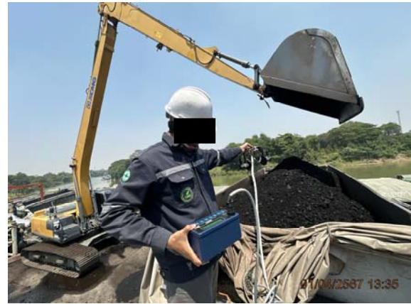
รูปที่ 3.3.3-9 ภาพถ่ายแสดงการตรวจวัดค่าความถี่แสงของฝุ่นละอองที่กระจายจากท่าเทียบเรือ
